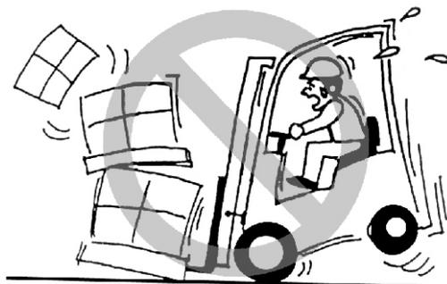
·Capacidade permitida significa qual a carga máxima pode ser colocada nos garfos de acordo com um centro de carga.
