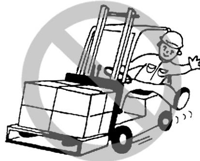
(14) Proibição de levantar ou inclinar cargas para a frente
